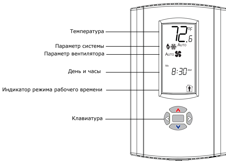
Рисунок 5. Программируемый зонный датчик и пример начальной страницы дисплея
