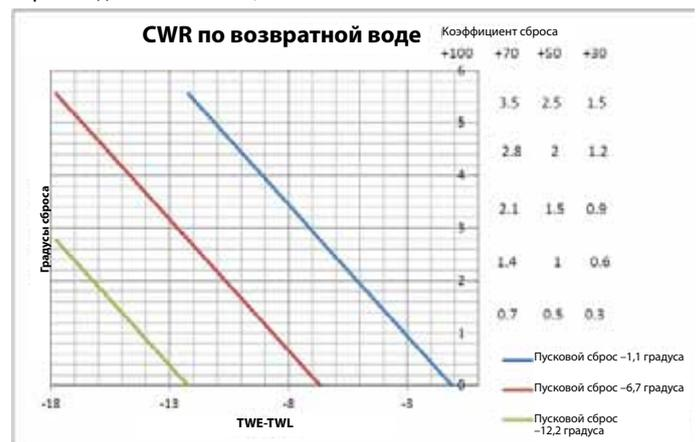
TWE – TWL представляет собой разность между температурой воды на входе испарителя и температурой воды на выходе испарителя.
