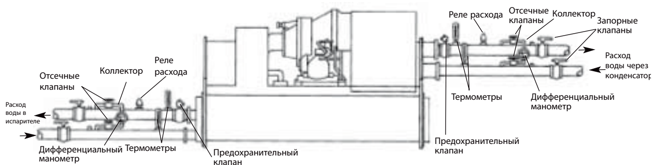
Рисунок 24. Типовые настройки термометра, клапанной системы и коллекторного манометра
