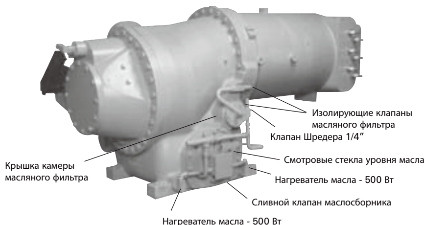
Рисунке 40. Компоненты системы смазки компрессора CVGF
